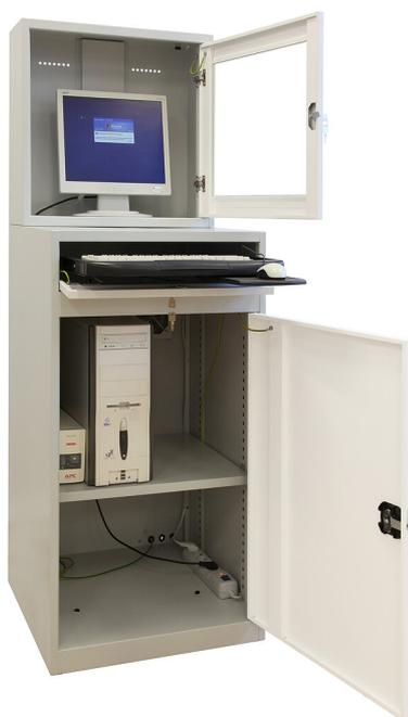
**Für Werkstatt und Betrieb. Inklusive aktiver Belüftung und 4-fach Steckdose. Stabile Stahlblechkonstruktion, pulverbeschichtet. Sichtscheibe aus Hartglas. Mit CE-Zeichen. Tastaturfach ausziehbar. Bildschirmkasten, Tastaturfach und Staufach für Rechner jeweils absperrenbar.**
