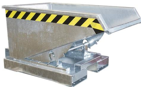
**kompakt, mit Abrollsystem, günstiger Lastschwerpunkt, Kippen in jeder Höhe per Seilzug vom Staplersitz. Wannennech mit umlaufendem Randprofil, stabiler Grundrahmen mit Einfahrtaschen, Sicherung gegen unbeabsichtigtes Abrutschen und Auskippen. Nachrüstbare Rollen.**
