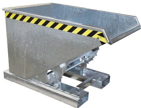
**kompakt, mit Abrollsystem, günstiger Lastschwerpunkt, Kippen in jeder Höhe per Seilzug vom Staplersitz. Wannenblech mit umlaufendem Randprofil, stabiler Grundrahmen mit Einfahrtaschen, Sicherung gegen unbeabsichtigtes Abrutschen und Auskippen. Nachrüstbare Rollen.**
