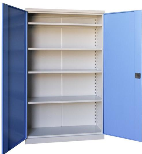
**Universalschrank, in 1 mm Stahlblechkonstruktion und Top-Qualität ! Extra breit, zur Aufbewahrung von Materialien, Kleinteilen und Werkzeug in Betrieb, Werkstatt und Lager. Tragfähigkeit je Boden 70 kg Zweiflügelig, absperrbar mit Schüsselschloß. Mit innenliegenden Türscharnieren. Abriebfeste Pulverbeschichtung.**
