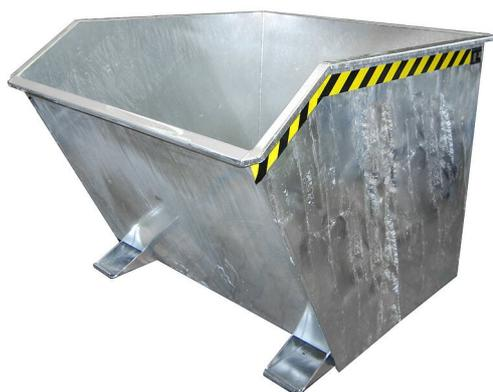
Mit geringer Bauhöhe, günstiger Kippwinkel, Kippen in jeder Höhe per Seilzug vom Staplersitz, Wannenblech mit umlaufenden Randprofil, stabiler Grundrahmen mit Einfahrtaschen, Sicherung gegen unbeabsichtigtes Abrutschen und Auskippen, Rollen nachrüstbar, mit umfangreichem Zubehör. In verschiedenen Farben verfügbar.
