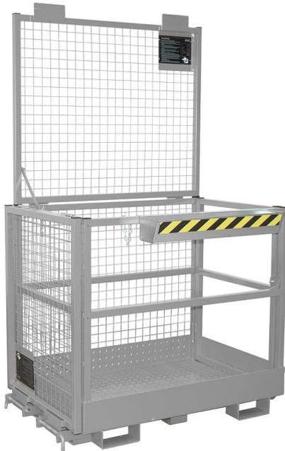
**Beidseitige (!) Aufnahme und Einfahrtschutz, Aufnahme mit Gabelstapler an der breiten und der schmalen Seite. Einfahrtschutz an den nicht verwendeten Einfahrtaschen. Stabile Vierkantrrohrkonstruktion. Quer- und Längsaufnahme. Rutschsichere Arbeitsplattform. Zulässig für 2 Personen. Einfahrtaschen mit Abrutschsicherung. Zwei klappbare Schutzgitter. TÜV geprüft, entsprechend DGUV.**
