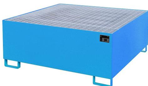
Zur Lagerung von Fässern, Containern (IBC) und Kleingebinden. 3 mm Stahlblechkonstruktion. Mit 100 mm Unterfahrhöhe, verzinkter Gitterrost (Tragfähigkeit 1000 kg/m<sup>2</sup>)
