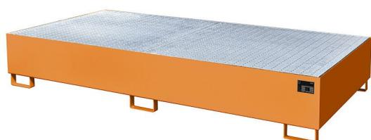
Zur Lagerung von Fässern, Containern (IBC) und Kleingebinden. 3 mm Stahlblechkonstruktion. Mit 100 mm Unterfahrhöhe, verzinkter Gitterrost (Tragfähigkeit 1000 kg/m<sup>2</sup>)
