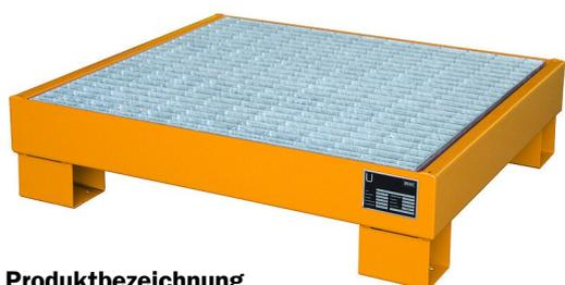
Zur Lagerung von 60 Liter-Fässern, auch mit Kleingebinden. 3 mm Stahlblechkonstruktion. Mit 100 mm Unterfahrhöhe, inklusive verzinktem Gitterrost. Tragfähigkeit 1000 kg/m<sup>2</sup>
