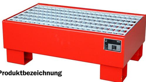
Zur Lagerung von 60 Liter-Fässern, auch mit Kleingebinden. 3 mm Stahlblechkonstruktion. Mit 100 mm Unterfahrhöhe, inklusive verzinktem Gitterrost. Tragfähigkeit 1000 kg/m<sup>2</sup>
